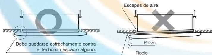
**PRECAUCIÓN** **Si hay un espacio entre el panel y el techo, ajuste la altura de la unidad interior. Al menos que ajuste la altura, puede que forme rocío y caer del espacio.**
